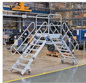
Передвижной переход, используемый в качестве рабочих подмостей и для преодоления препятствий
