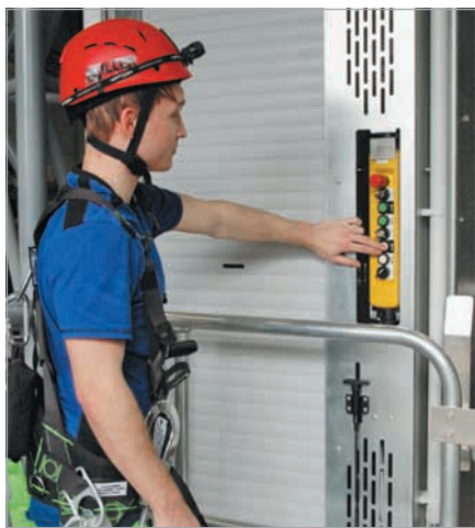
Роллета с вынимающимся пультом управления
