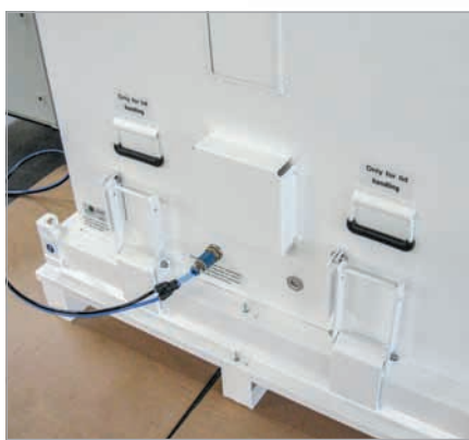
Контейнер во время проверки герметичности избыточным давлением
