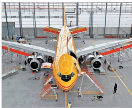
Док для самолётов Boeing-757 и Airbus A300
