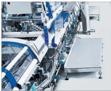
Рабочая подмость с регулируемой высотой ножек для обслуживания установки
