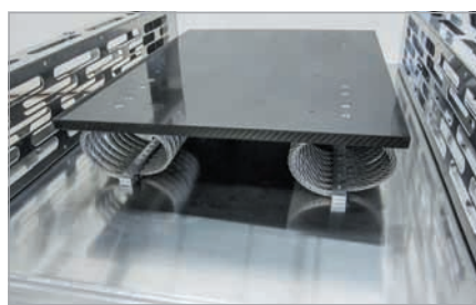
Амортизирующая платформа с резиновыми или тросовыми демпферами.
