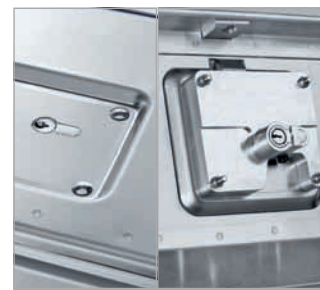
Автоматический замок в углублении для максимальной защиты. Открывается только уникальным ключом. Литой алюминиевый корпус замка.
