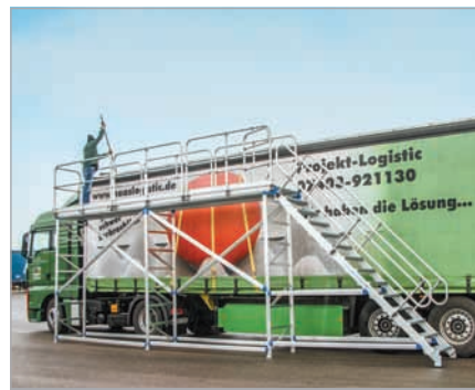
Подмость для очистки фур от льда
