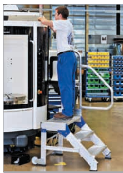
Лестница-подмость для монтажа машин и оборудования
