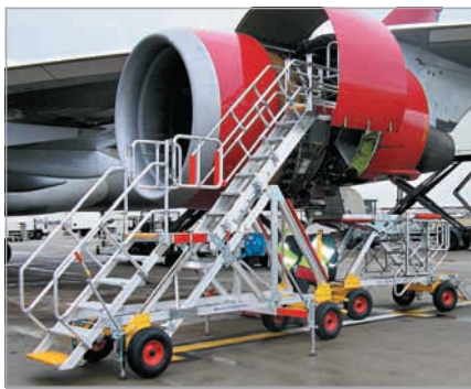
Адаптированная к типу самолёта платформа фиксированной высоты для техобслуживания
