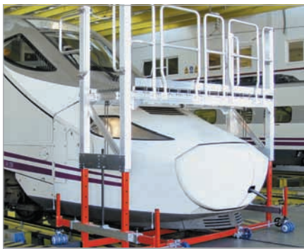
Регулируемая по высоте фронтальная платформа на рельсовом шасси
