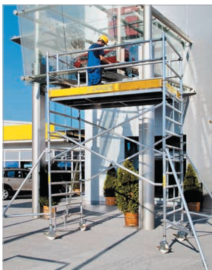
Передвижные вышки без связей могут быть шириной 0,75 м или 1,35 м, а высотой – до 10,40 м. Связи могут отсутствовать до высоты 1,90 м.
